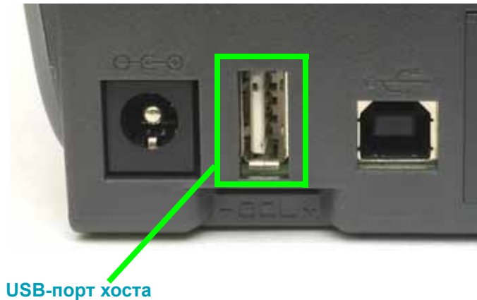
Рис. 1 • Расположение USB-порта хоста
