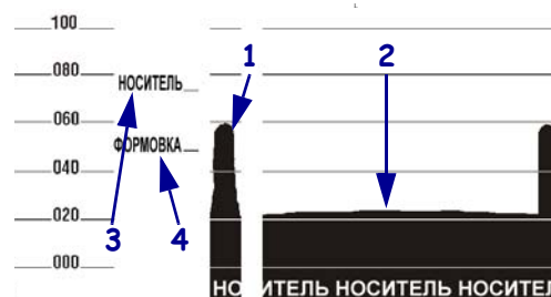
рис. 29 • Профиль датчика (участок носителя)
