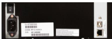
Благодаря встроенным LAN и USB интерфейсам, CL-E730 может быть подключен в системы различной конфигурации.
