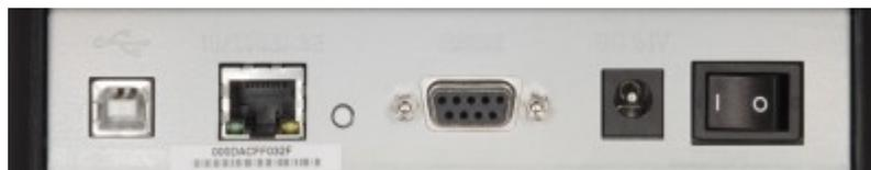
Имеет встроенные LAN, USB и последовательный интерфейсы.
